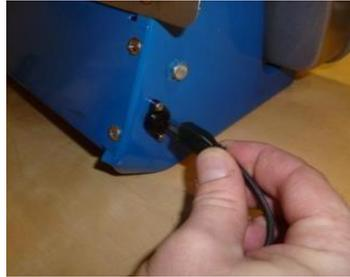
**b.-Se inspecciona la unidad de encendido:** Se presiona el botón de encendido y se escucha para asegurar que la bujía haya hecho chispa para iniciar el proceso de encendido.
