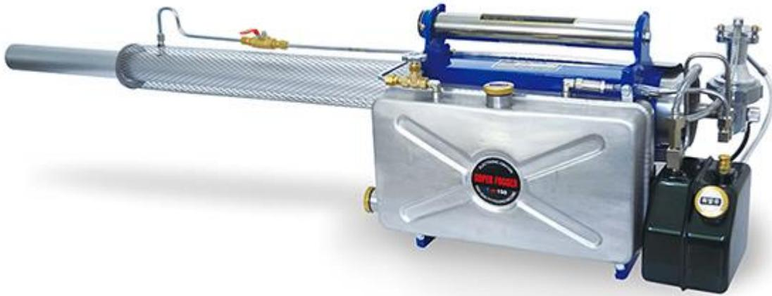
Los termonebulizadores **PESTWORKER®** cuentan con encendido automático; nebulizan por medio de aire comprimido. Al presionar el botón de encendido, inicia la compresión. El aire comprimido también presuriza el depósito de combustible lo cual resulta en una inyección de combustible desde la boquilla hacia el carburador.
